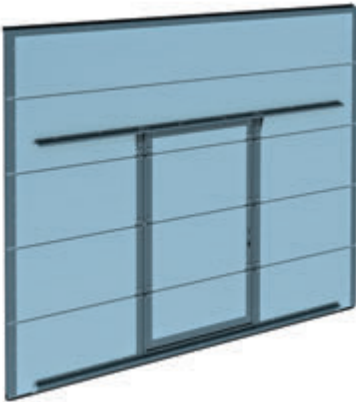
Wicket with low threshold 95 mm Schlupftür mit niedriger 95 mm Schwelle
