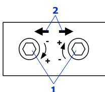
**Рисунок 3.** Настройка конечных положений
