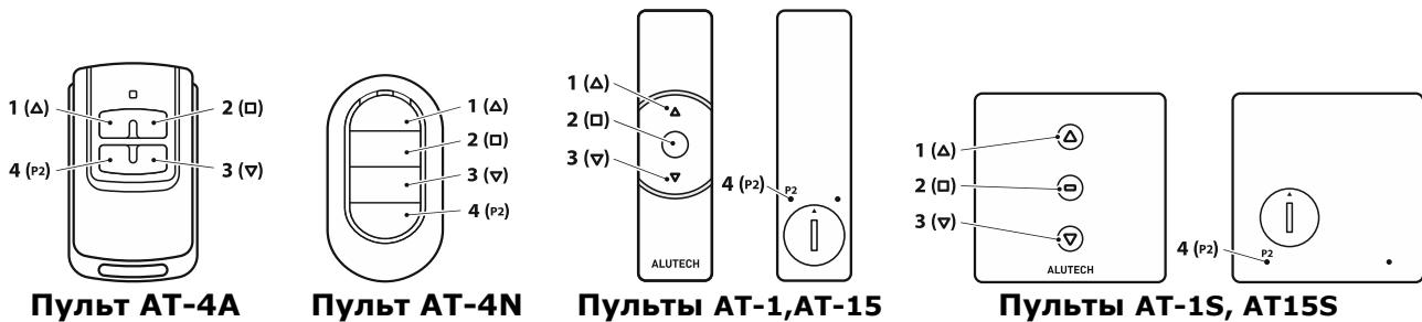
**Рисунок 2 – Внешний вид пультов радиоуправления и назначение кнопок:**
