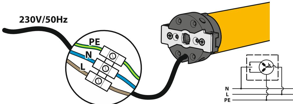
**Малюнок 1. Схема електричного підключення**
