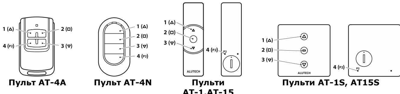
**Малюнок 2** – Зовнішній вигляд пультів радіоуправління та призначення кнопок:
