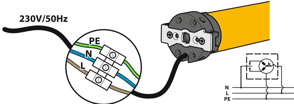
**Рисунок 1.** Схема электрического подключения
